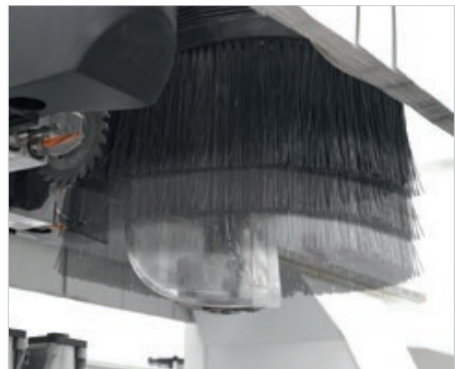
Coiffe d'aspiration réglable sur 8 positions (pour 4 axes) et 12 positions (pour 5 axes).
