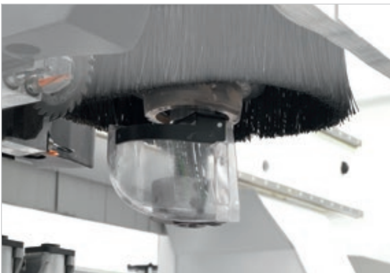
Défecteur (transporteur de copeaux) géré par contrôle numérique.
