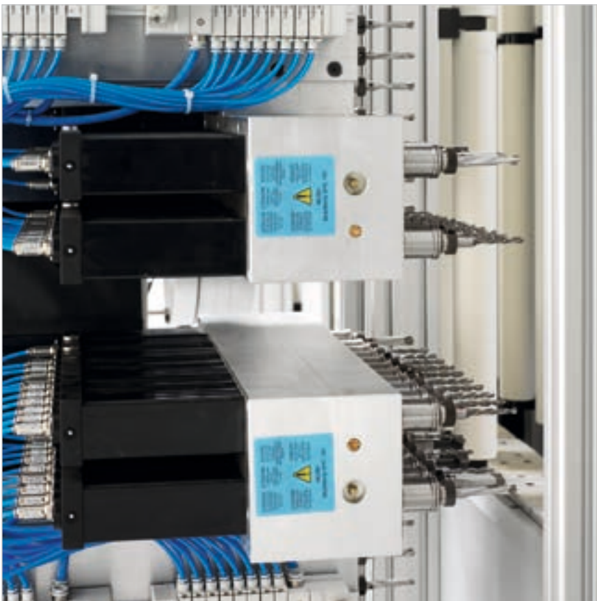
↙ Grupo de mandriles independientes para mecanizados de taladrado personalizados.
