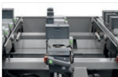
SA (设定辅助系统) 设定辅助工作台建议操作员如何定位板件 (指示工作台和吸盘的位置)，并且保护工作区域避免发生刀具碰撞。
