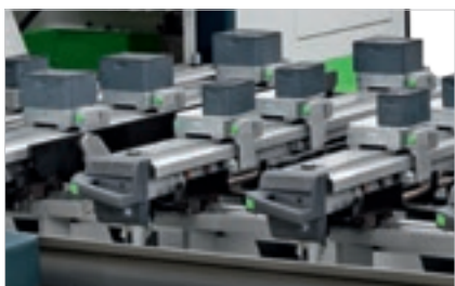
ATS (高级的台面设置系统) 应用于快速、简便的手动定位夹紧系统
