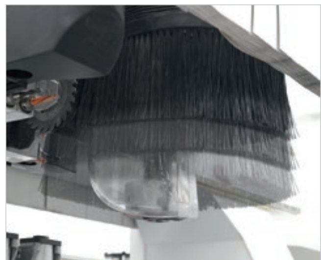
Caixa de aspiração regulável com 8 posições (para 4 eixos) e 12 posições (para 5 eixos).
