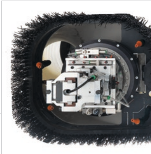
Abblaseinheit mit 4 Ausgängen, auch mit den Aggregaten für die Feinbearbeitung der Kante verwendbar.
