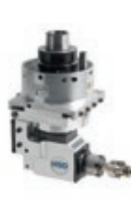
Doppelt getastetes Bündigfräsag- gregat.
