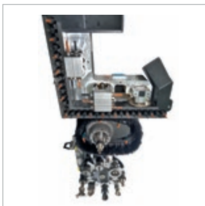
Устройство для горизонтального сверления мощностью 6 кВт.
