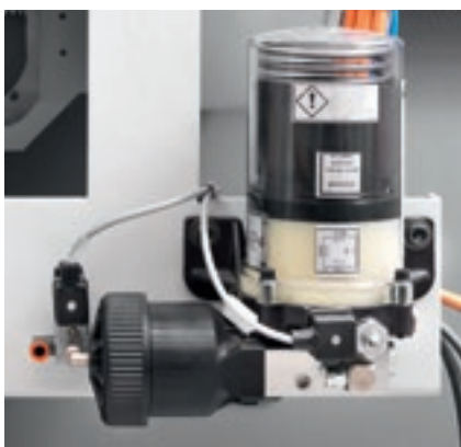
Lubrification automatique tête de perçage BHZ 29 2L.
