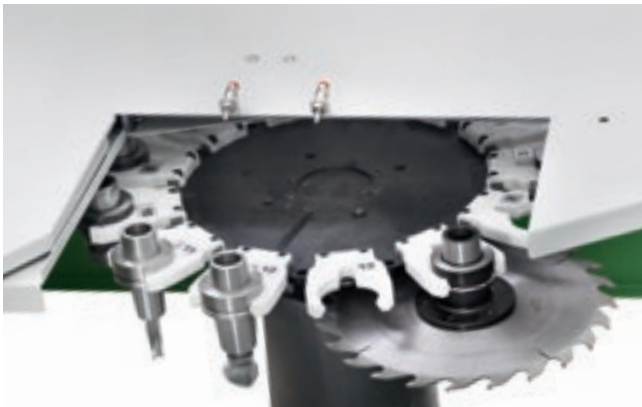
Magasin outils à revolver 13/16 positions.
