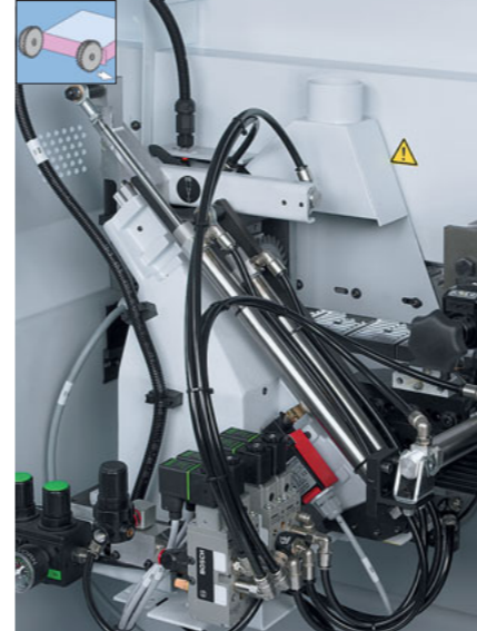
Kappaggregat Exakter Kappschnitt durch robustes Kappaggregat mit hochpräziser Linearführung.
