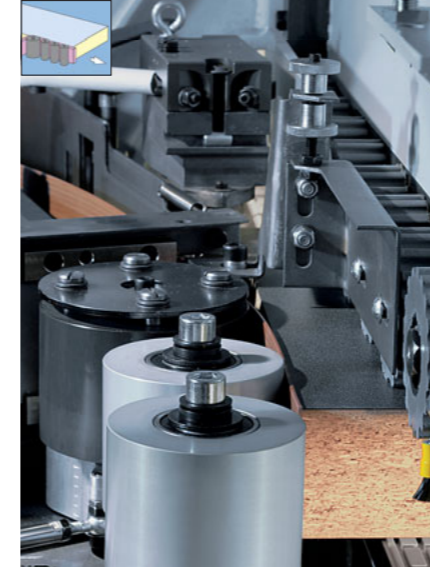
Druckzone Schwere Druckzone bis 8mm Kantenstärke und 60mm Plattenhöhe für eine optimale Leimfugenqualität.
