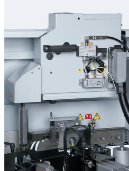
Vorschmelzer (optional) Hohe Verfügbarkeit und optimale Leimqualität durch Quickmelt Verleimteil.
