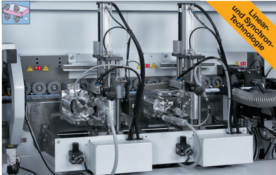
Multifunktions-Fräsaggregat (Ambition 1440 FC) Zum Bearbeiten der Kantenüberstände an der Werkstückober- und unterkante sowie zum Eckenkupieren der Vorder- und Hinterkante. Ausgerüstet mit automatischer Verstellung zwischen Dünn- und Dickkante. Werkstückdicke 60 mm.
