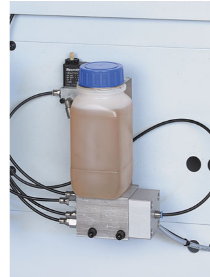
Zentral-Schmiereinheit Zur Schmierung der Kettenbahnführung für einen langlebigen und präzisen Lauf der Transportkette.
