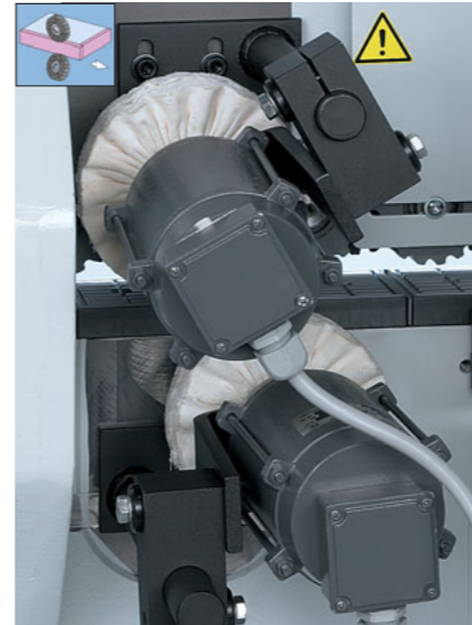
Schwabbelaggregat Zum Polieren von Kanten für natürliche Farbtreue.
