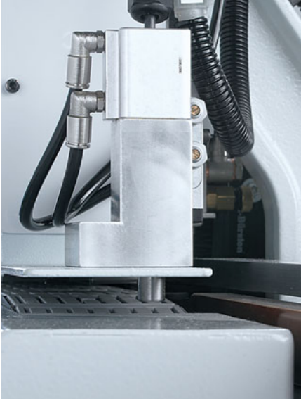
Einlaufsperr Für einen minimalen Werkstückabstand und eine sichere Bedienung.
