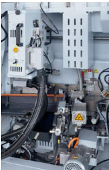
Agregado para activación de la capa funcional de los cantos, para un espesor de pieza de 8 - 40 mm. La unidad de reactivación **airTec** se instala de tal manera que se puede trabajar tanto con la unidad aplicadora estándar como con el sistema **airTec**. Para **airTec** se pueden utilizar los cantos aptos para láser encontrados en el mercado.
