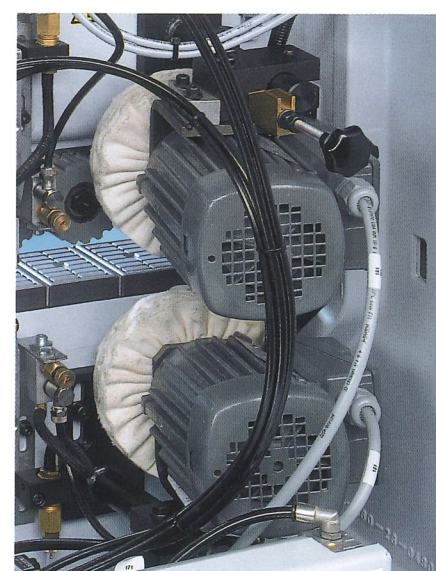
Schwabelaggregat Zum Polieren von Kanten für natürliche Farbtreue.
