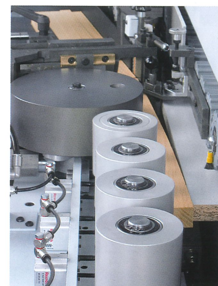
Druckzone (KDF 900er) Schwere Druckzone (bis 20 mm) für eine optimale Leimfugenqualität.
