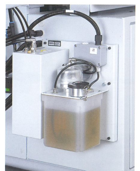
Zentral-Schmereinheit Vollautomatische Schmierung der Kettenbahnführung für einen langlebigen und präzisen Lauf der Transportkette.
