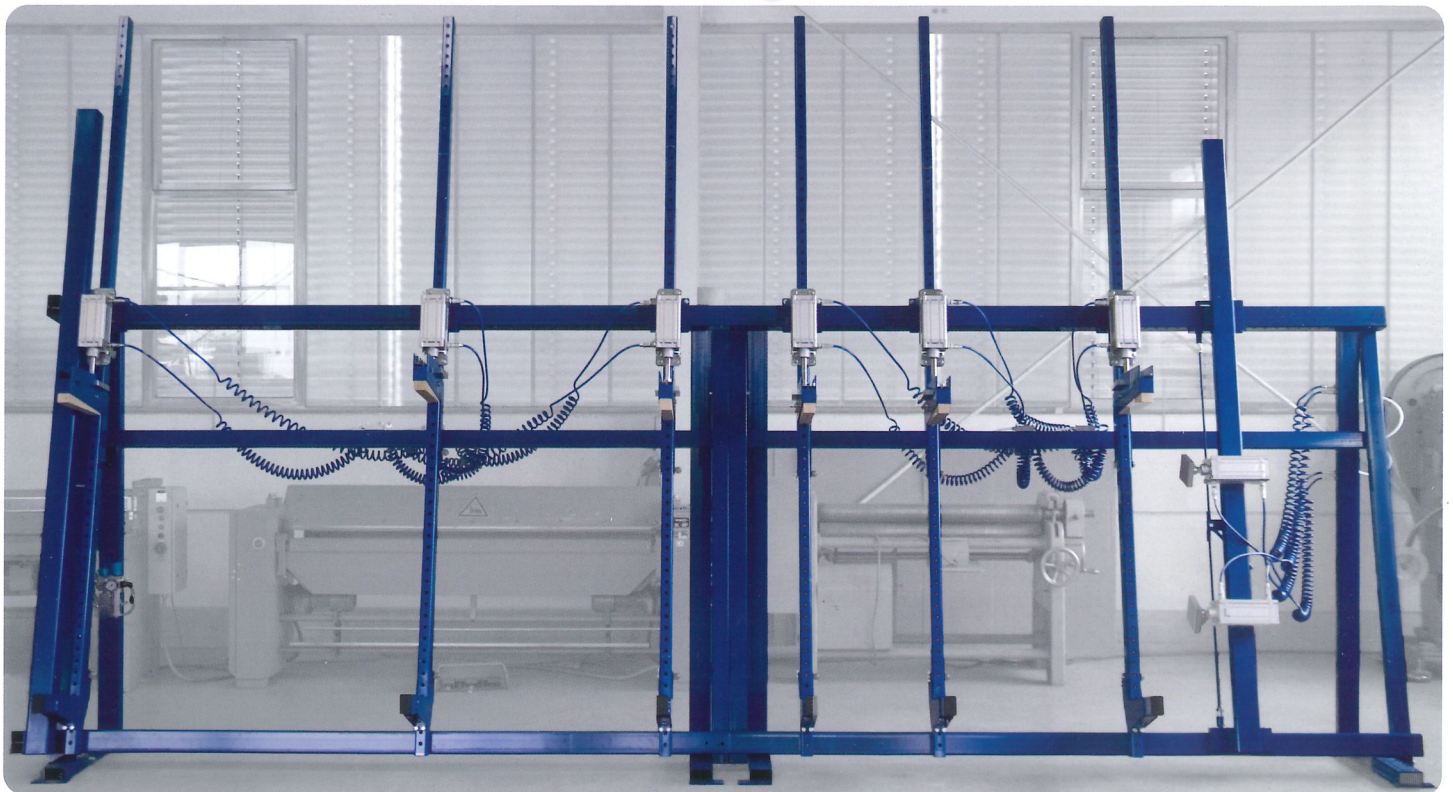
Abb.: Sonderlösung für einen namhaften deutschen Automobilhersteller zum Verkleben von Styroporkernen für den Modellbau.
