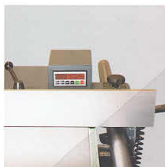
▲ Visualizzazione digitale delle misure sulla guida parallela.
