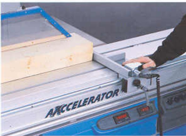
Carro ad 8 rulli in acciaio, motorizzato (AXcelerator).
