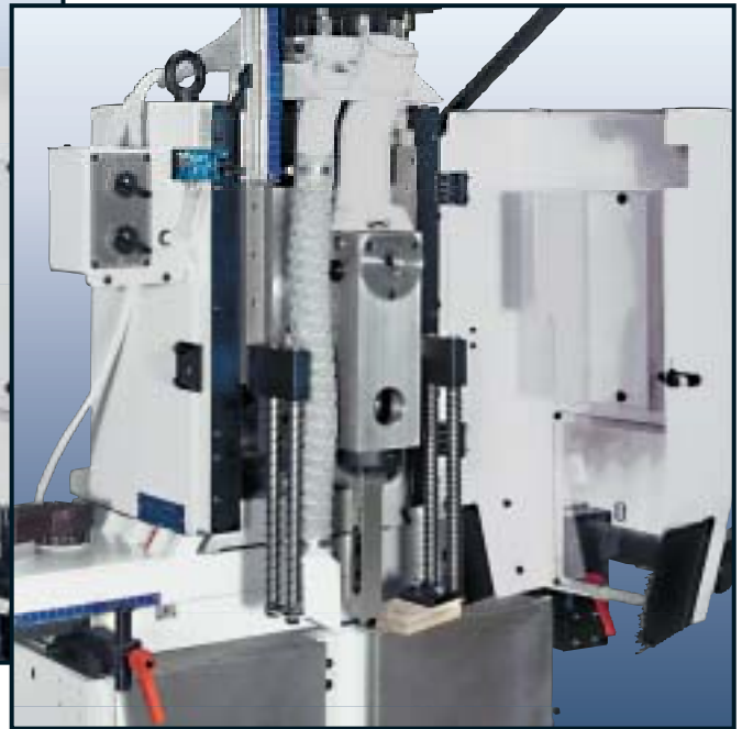
Particolare dell'unità porta-bedano. Detail de l'unité porte-bedane. View of chisel-holder unit. Detailansicht des Lochbeitelaggregates.
