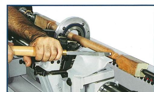
Supporto a ventaglio per eventuali finiture manuali. Support à éventail pour d'éventuelles finitions manuelles. Tool support rest for occasional hand turning finishes. Stahlauflage für eventuelle manuelle Nachbearbeitungen.
