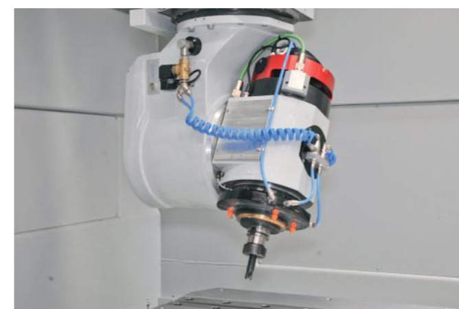
Testa di taglio a 5 assi con tecnologia direct drive
