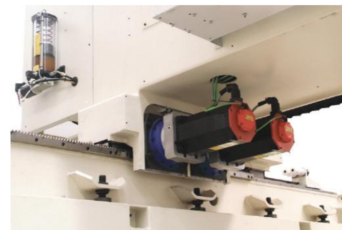
Cinematica con recupero gioco elettrico (doppio motore) per garantire maggiore rigidità e precisione
