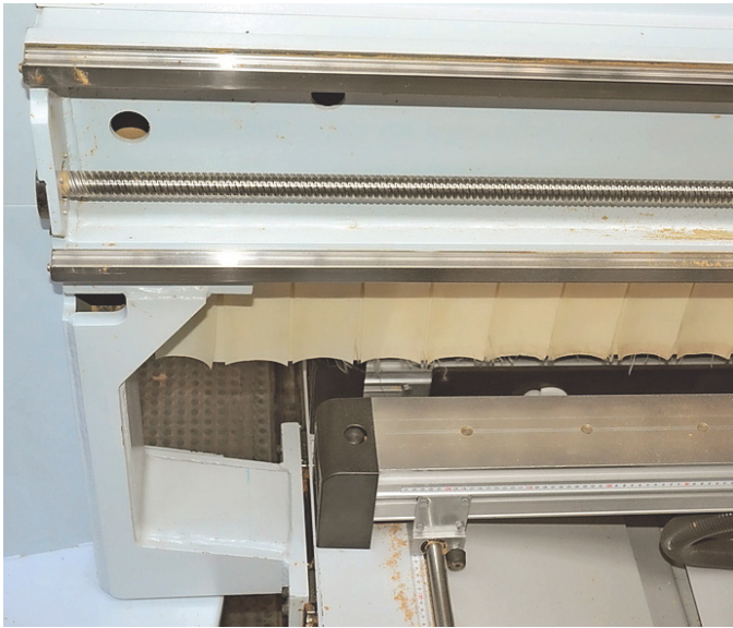
CNC-Bearbeitungszentrum mit Ausleger, der auf einer Seite angetrieben, auf der anderen nur abgestützt ist
