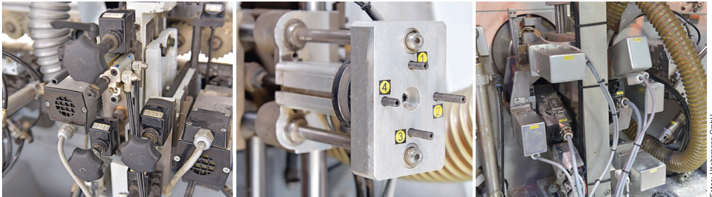
Automatisierungsstufen in Sachen Aggregateverstellung: manuell, pneumatisch, elektromotorisch (v.l.n.r.)
