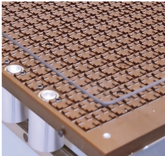
Tischvarianten: Matrix- oder Raster- tisch mit Moosgum- mischsnüren (I.), Kon- solentisch mit einzel- nen Vakumsaugern
