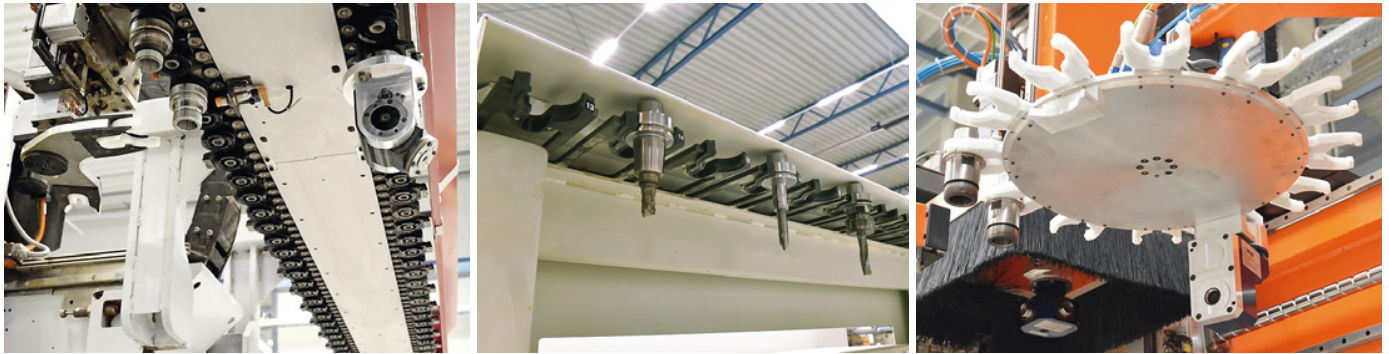
Kettenwechsler mit Übergabevorrichtung, Pickup-Wechsler, mitfahrender Tellerwechsler (v.l.n.r.)
