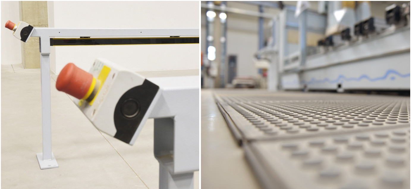
Lichtschranken und Trittmatten findet man dagegen nur noch selten, da sie die Zugänglichkeit zur Maschine stark einschränken
