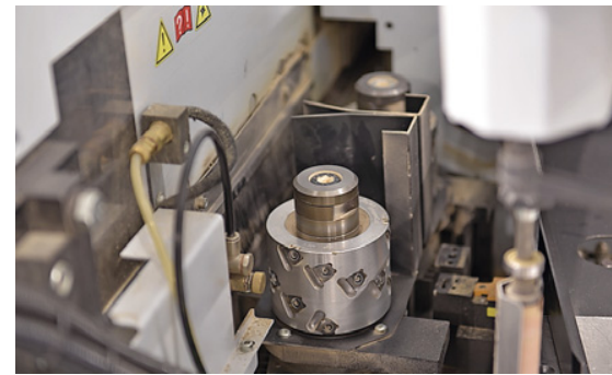
Für Fügefräsaggregate macht der Einsatz von Diamant-Fräswerkzeugen Sinn
