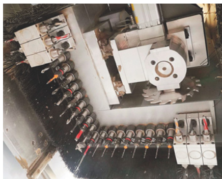
Wie viele Bohrer braucht der Mensch? Links ein großer Bohrblock mit über 21 Bohrern und Nutsäge, rechts ein kleiner Bohrblock
