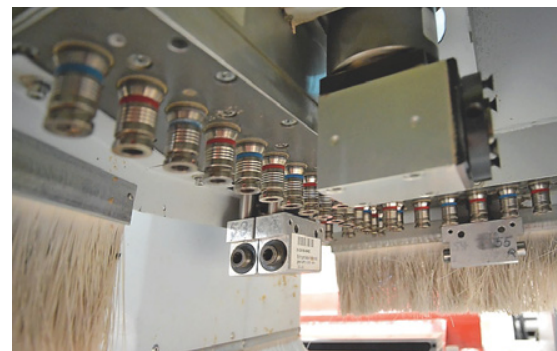
Großer Bohrblock mit 15 Lochreihenbohrern, Topfbandbohrer und Nutsäge
