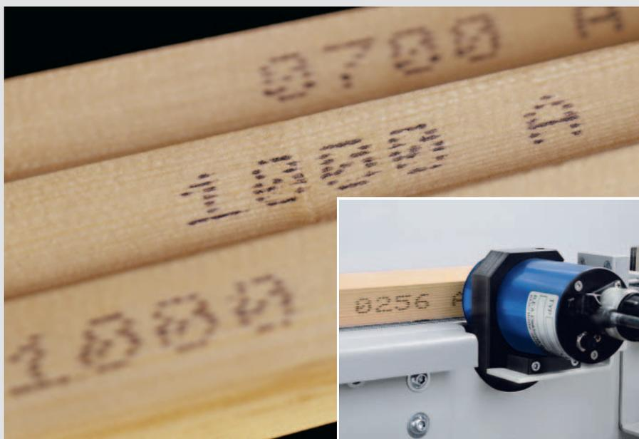
Кодирование деталей применяется для того, чтобы было легче отслеживать их распределение после прирезки, то есть идентифицировать каждую деталь при транспортировке, складском хранении или комплектовании заказов. Такой способ помогает снизить издержки, улучшить контроль продукции и в целом способствует внедрению рентабельных методов производства. Коды, цифровые или штриховые, наносятся прямо на детали – сбоку или сверху.
