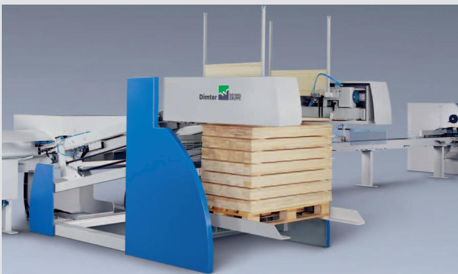
**OptiCut Stacker** эффективно дополняет торцовочную линию, когда прирезка ведётся с получением деталей определённой длины: на выходе они автоматически укладываются в штабель высотой до 1200 мм. Частота поступления деталей – до 80 в минуту. При этом конфигурацию штабеля можно выбирать непосредственно через систему управления.
