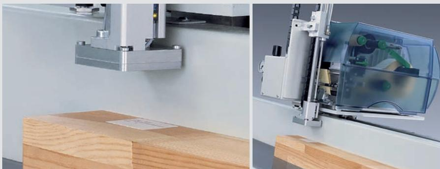
Mit dem **Etikettendrucker** können Etiketten vollautomatisch erstellt und aufgebracht werden. Der Drucker ist dabei voll in die Steuerung der OptiCut S 90 integriert. Über den Barcode wird die Teileidentifikation sogar maschinenlesbar und weitere Prozessmaschinen können sich entsprechend auf das Werkstück einstellen. Individuelle Etikettendesigns sind hierbei kein Problem.
