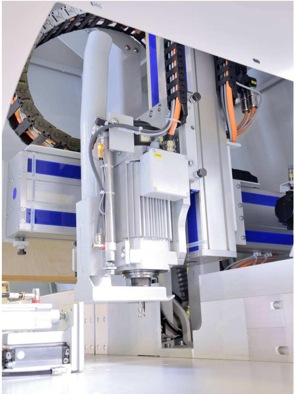
Die S 90 XL Superdrill mit Bohraggregat zum Kappen, Bohren und Fräsen
