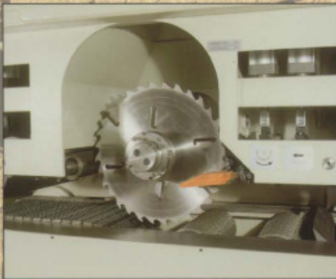
Detalle sistema de arrastre y evacuación residuos. Détail de système d'entraînement et évacuation des éclats, des cales... Detail of feeding system and residue evacuation.
