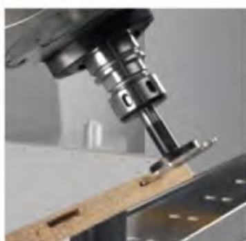
Otworki pod złączki Clamex P
