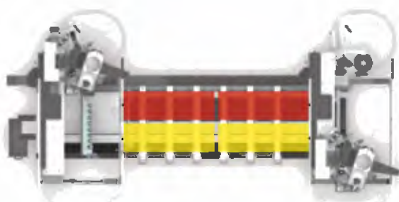
2 pola robocze w osi X do obłożenia wahadłowego z przednim i tylnym rzędem ograniczników
