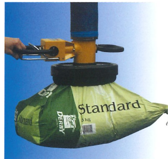
VacuPowerlift VPL mit Sack-Saugfuß SFS 190x290K in Kunststoffausführung für Papier- und Kunststoffsäcke.
