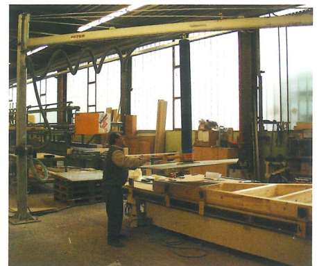
Säulenschwenkkran SSK 160-6.000 für Lasten bis 80 kg
