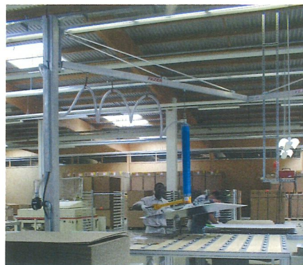
Säulenschwenkkran SSK 125-4.000 für Lasten bis 60 kg
