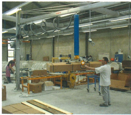
Säulenschwenkkran SSK 125-4.000 für Lasten bis 80 kg
