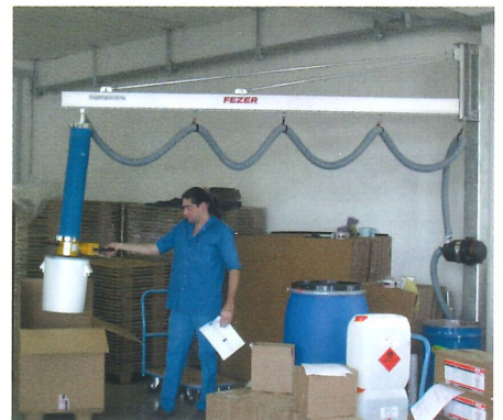
Säulenschwenkkran SSK 125-4.000 für Lasten bis 40 kg
