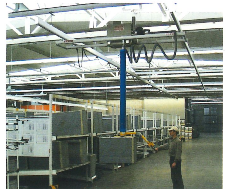
Hängebahnsystem mit Doppelbrücke und Deckenabhängung. Arbeitsfläche: 32.000 x 5.000 mm
