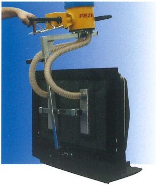
VacuPowerlift VPL mit Spezial-Saugfuß für den Transport von Fernsehgeräten.
