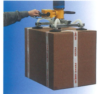
VacuPowerlift VPL mit Vierfach-Saugfuß SFV 115 FBS in Faltenbalgausführung für verklebte und offene Faltkartons.
