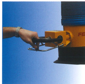
Steuergehäuse mit Kipphebel. Der Hubschlauch wird durch hoch- oder niederdrücken des Bedienhebels angesteuert.
