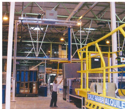
Hängebahnsystem mit selbststehender Portalkonstruktion. Arbeitsfläche: 22.000 x 5.000 mm
