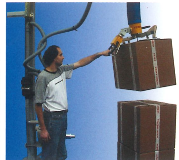
Gelenkige Verlängerung: Zum Stapeln in großer Höhe
