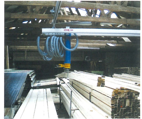
Hängebahnsystem mit Balkenabhängung. Arbeitsfläche: 10.000 x 8.000 mm
