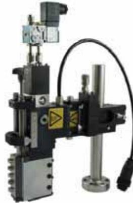
**Anstatt Ihr vorhandenes Walzensystem wird ein Flächenauftragskopf installiert. Mit dem Flächenauftragskopf lassen sich Kantenhöhen bis 60mm verarbeiten. Verstellt wir die Auftragshöhe manuell mit einer Verstellerschraube.**
