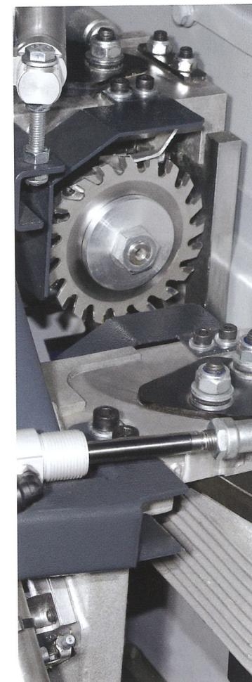
El dispositivo de cizalla se compone de dos unidades de sierra independientes, equipadas con motores de alta frecuencia (12.000 rpm). Las guías lineales garantizan una muy alta precisión. Los dispositivos de cizalla son giratorios de 0° a 15° - según el equipamiento, la inclinación es manual o neumática, controlada por el panel de mando (p.ej. corte a 15° solamente sobre la pieza en la parte delantera, o trasera, o en la parte delantera y trasera).
