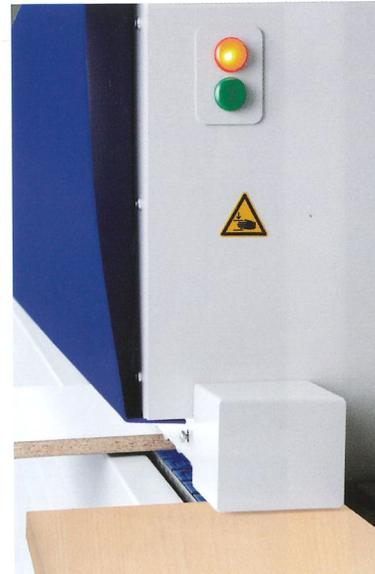
Un cilindro neumático situado en la parte delantera de la máquina libera la próxima pieza de este modo el usuario no es obligado a prestar atención en el dispositivo de señalización. El sistema de seguridad del guiado de pieza garantiza así un proceso de seguridad mucho más confortable.
