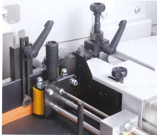
Según la aplicación, es posible mecanizar un material de cantos de 0,4 a 3,0 mm y un material de bandas hasta 10 mm de espesor para unos tableros hasta 60 mm en altura. Un sensor infrarrojo detecta la presencia del material de cantos antes del mecanizado. El dispositivo de cizalla para el recorte preliminar del material de rodillos es estudiado para una dimensión máxima de 3x 64 mm.
