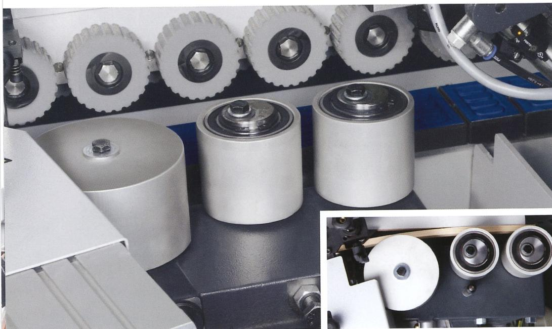
El primer cilindro, de construcción masiva y con posicionamiento por mando, aprieta el material de cantos sobre la pieza. El posicionamiento por mando impide así el ensuciamiento de la cola y el "engancho" del material de cantos. Ambos cilindros posteriores cónicos cierran la junta sobre la parte superior e inferior.
