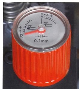
Los contadores de precisión garantizan un ajuste rápido y preciso de todas las unidades de los modelos x-motion. En todos los modelos e-motion, el ajuste se hace por posicionamiento motorizado a través de la pantalla táctil en color.
