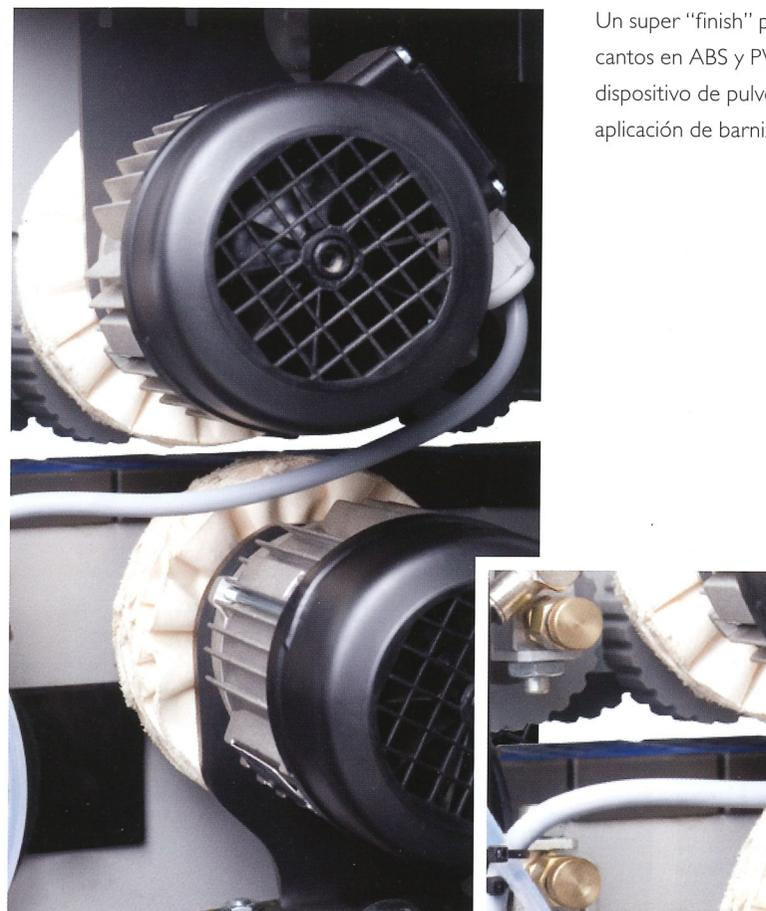
Un super "finish" para un material de cantos en ABS y PVC. A petición, un dispositivo de pulverizador para la aplicación de barniz sobre la pieza.
