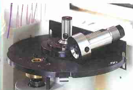
Ручная система быстрой смены инструмента.
