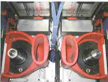
RANDOMAT мод.002 с подрезным агрегатом RANDOMAT 002 Ausführung mit Ritzaggregat. RANDOMAT version 002 with scoring unit.
