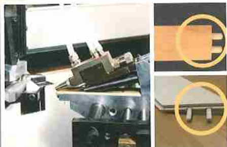
Агрегат "R" для нанесения клея/вставки шкантов. Leimeingabe- und Dübeleintreibaggregat "R". Glue injection/dowel inserting unit "R".
