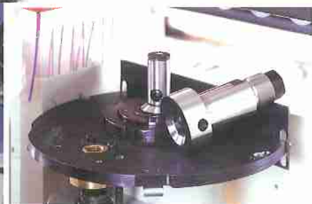
Ручная система быстрой смены инструмента, мод. "FRIULMAC".
