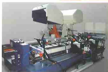
Мост для установки горизонтальных агрегатов для фронтальной обработки
