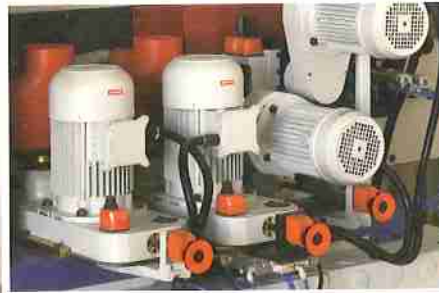
CONTOURAMAT мод. 006 с подвижным профилирующим агрегатом
