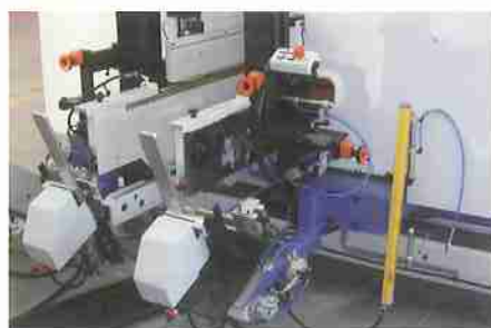
Система возврата заготовок с автоматическим укладчиком.
