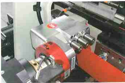
Сверлильный блок с системой быстрой смены инструмента "HSK 63 C"
