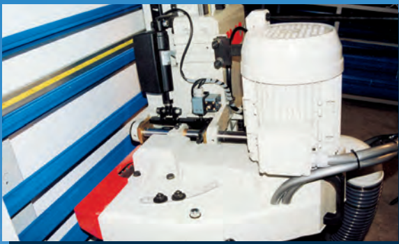
Ribaltamento del gruppo sega di 90° in automatico 90° rotation of the saw unit in automatic mode
