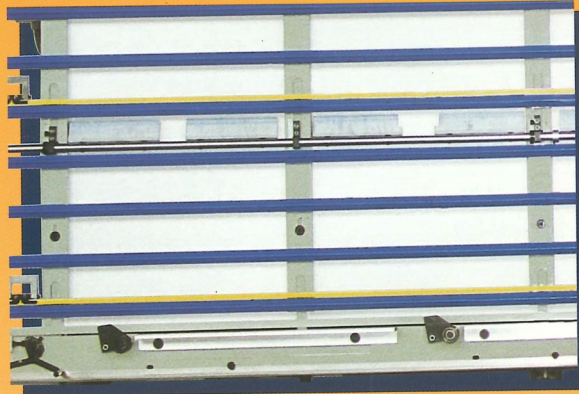
Rouleaux escamotables pour le déplacement des panneaux Rodillos ocultables para el desplazamiento de los paneles Klappbaren und versenkbare Rollen zur Pannee-Verschiebung
