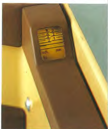
Das praktische Sichtfenster zum Einstellen der Spanabnahme
