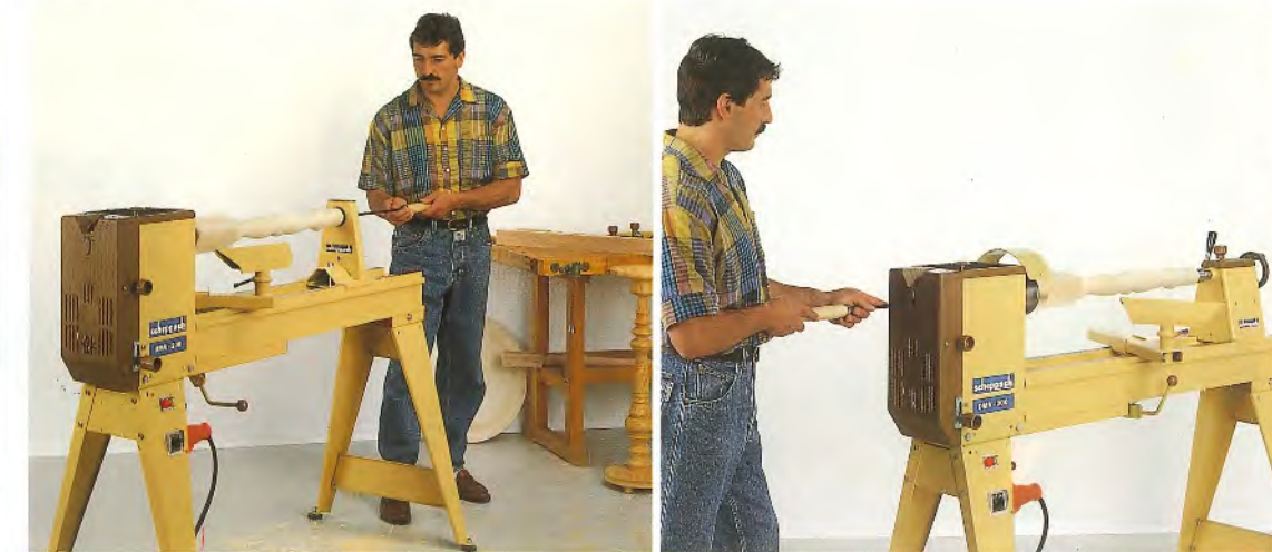
Einsatz des Löffelbohrers mit Bohrersetstock
