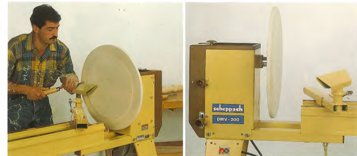
Ausziehbares Maschinenbett für Spitzenhöhen bis max. 315 mm und Spitzenlängen bis max. 1100 mm
