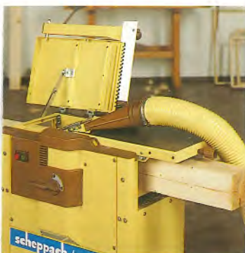
Späne-Auswurfhaube beim Dickenhobeln.
