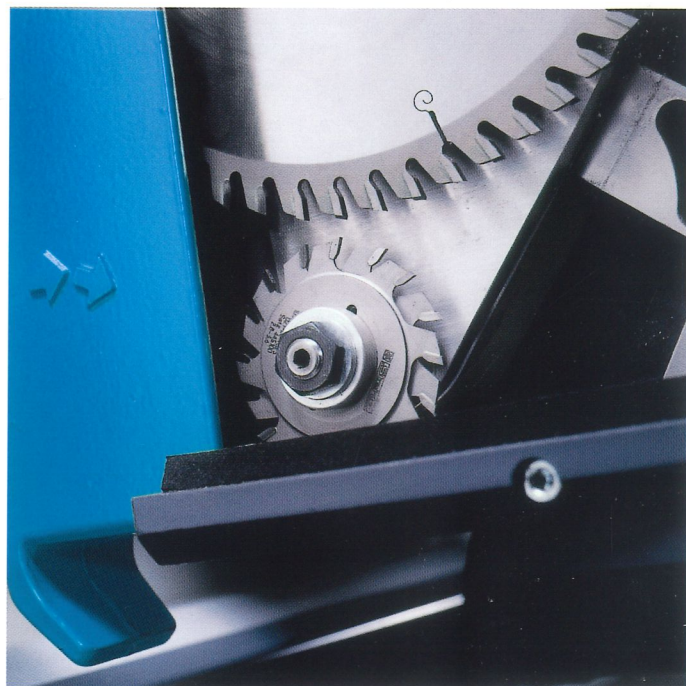
Inciseur Agrégat inciseur intégré sur l'arbre principal. Pas de réglage axial. Inciseur escamotable.
