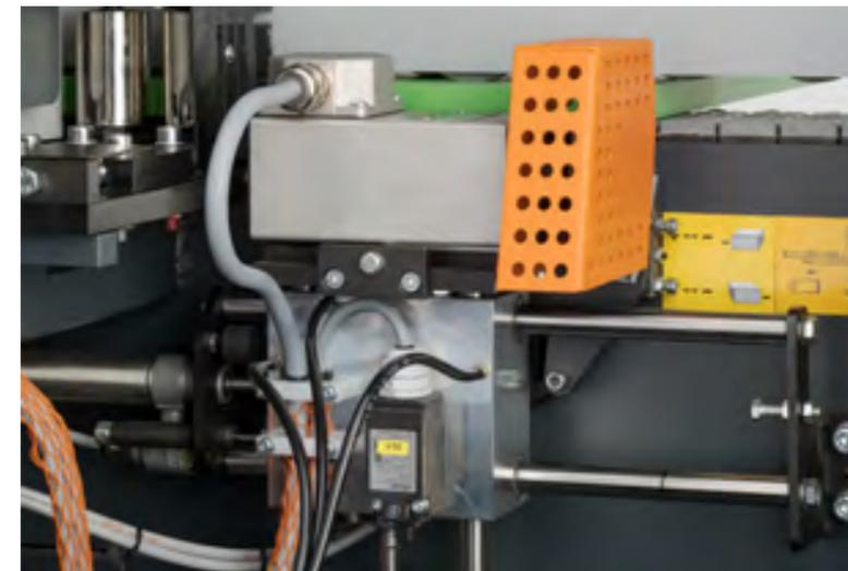
**Kappsägestation:** Die stabile Bauweise der einmotorigen Kappsäge mit Linearführungen ermöglicht das präzise Sägen der Werkstück Vorder- und Hinterseite. Die Einstellung erfolgt über die Display-Steuerung einfach von der Maschinenvorderseite aus.
