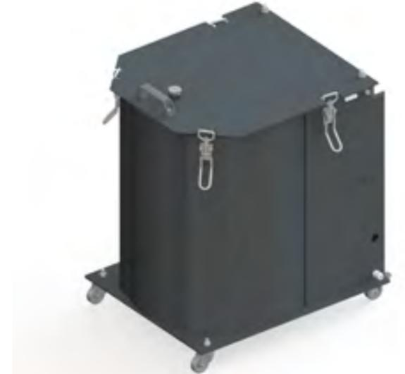
**PUR-Box:** Unsere PUR-Box verlangsamt mittels Druckluft-beaufschlagtem Trocknungsverfahren das Aushärten des PUR-Leims im Leimbecken und verlängert so die mögliche Verarbeitungszeit des Klebers auf bis zu 7 Tage, bevor ein vorzeitiges Reinigen nötig wird. Gerade bei der regelmäßigen Verarbeitung von PUR-Leim empfehlen wir Ihnen dieses Zubehör.
