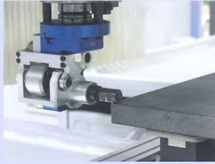
Getastetes Bündigfräsen der Kantenüberstände am Postformingprofil.
