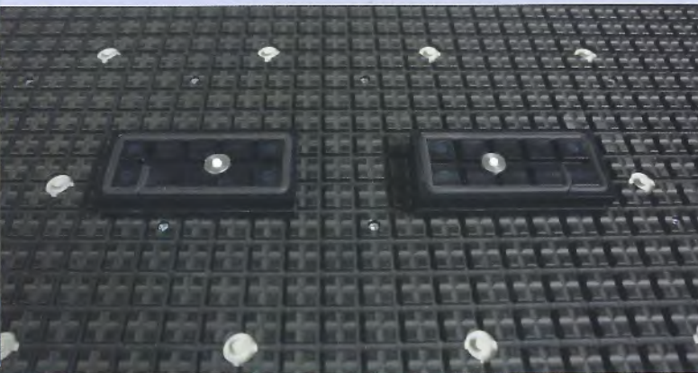
Vakuumspanner für MATRIX-Tisch 168 x 78 x 26 mm
