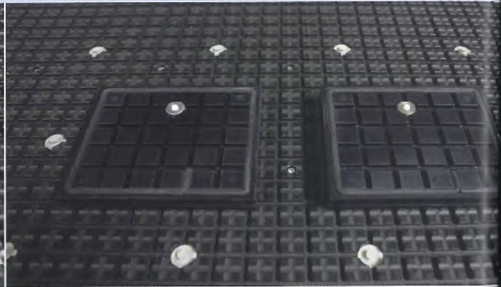
Vakuumspanner für MATRIX-Tisch 198 x 168 x 26 mm
