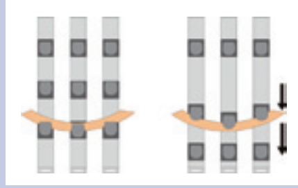
Automatisches Umspannen der Einzelteile für doppelseitige Bearbeitung.
