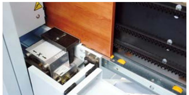
Werkstückspannzange Einfaches Einstellen der Spannzange (manuell) auf Werkstückdicke (Spannzangenhub 10 mm). Bei Werkstückdickenunterschieden von bis zu 10 mm ist keine manuelle Einstellung der Spannzange notwendig.
