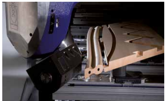
Staketenbohrungen in engem Winkel
