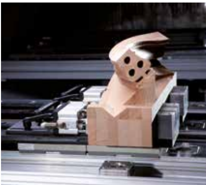
Klemmvorrichtung sorgt für sicheres und schnelles Spannen von Pfosten und Kanteln.
