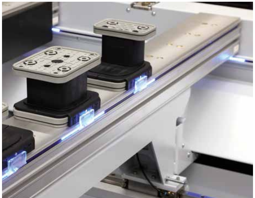
LED-System wohl das schnellste und sicherste Positioniersystem für Konsole und Spannelemente (patentiert).
