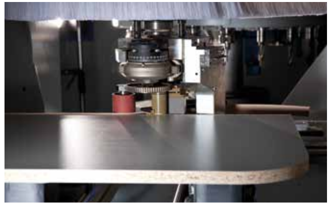
Verleimaggregat easyEdge zum rationellen Anleimen an Formteile
