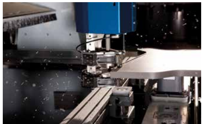
Perfektes Kantenfinish durch getastetes Kombi-Bündigfräs-/Nachputzaggregat
