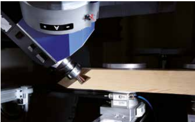
Fräsen einer Gratverbindung für Pfosten-/Riegelkonstruktionen
