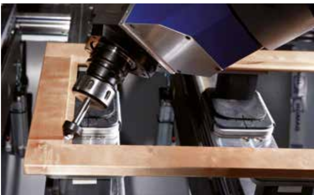
Eckiges Ausspitzen einer Glasfalz-Ecke
