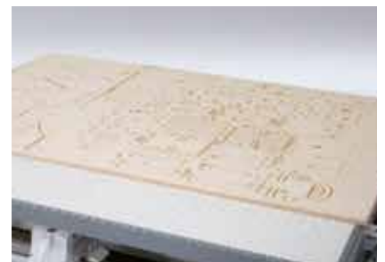
Matrix-Adapterplatte bietet auch bei filigranen Werkstücken eine sichere Fixierung. Mit der Matrix-Adapterplatte können auch auf einer Konsolentischmaschine Formteile im Nesting-Verfahren verschnittoptimiert „zugeschnitten“ werden.
