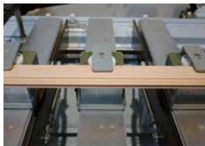
Multispanner für Zweikreisvakuumsystem. Vakuumbetätigtes Spannelement zum Spannen von Leisten und Kanteln.
