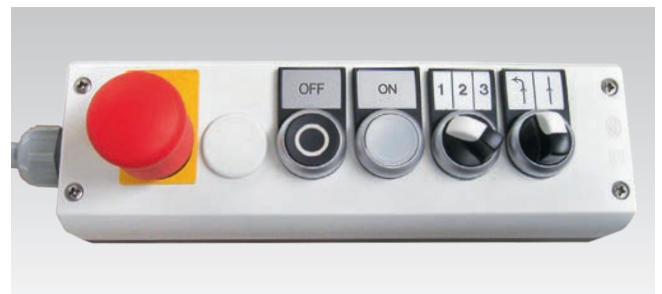
Bedieneinheit Separates Bedienfeld am Einlauf der Kantenanleimmaschine.
