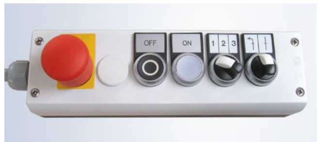
Bedieneinheit Separates Bedienfeld am Einlauf der Kantenanleimmaschine.
