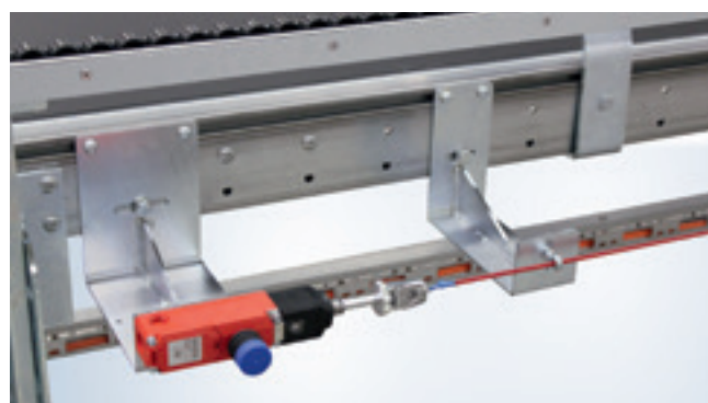
Equipement pour conformité CE : câble le long de la bande retour
