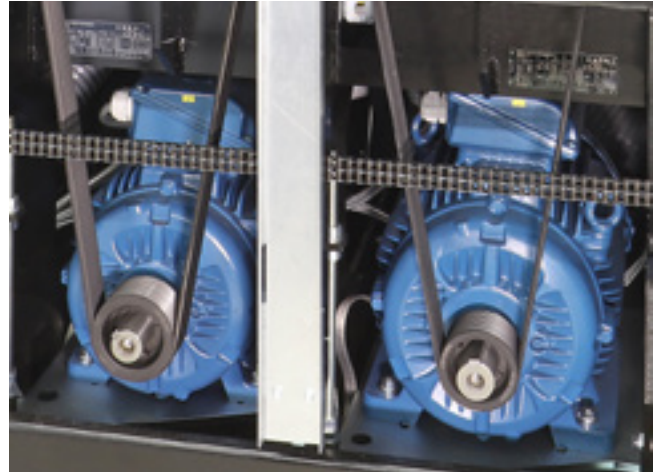
Separate Antriebsmotoren für jedes Aggregat
