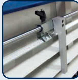
▶ Lineal zur Längeneinstellung beim Vertikalschnitt
