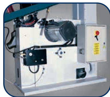
Schrägstellung des Tisches über Zahnstange und automatischer Stern/Dreieck-Schalter
