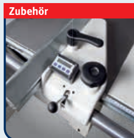
▶ Mit Digitalanzeige für die Schnittbreite am Parallelanschlag Art.-Nr.: 5516000
