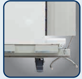
▶ Praktischer Fußhebel zum Anheben und leichteren Positionieren großer Platten auf der Säge
