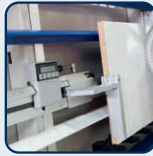
▶ Digitale Maßanzeige zur Längeneinstellung beim Vertikalschnitt
