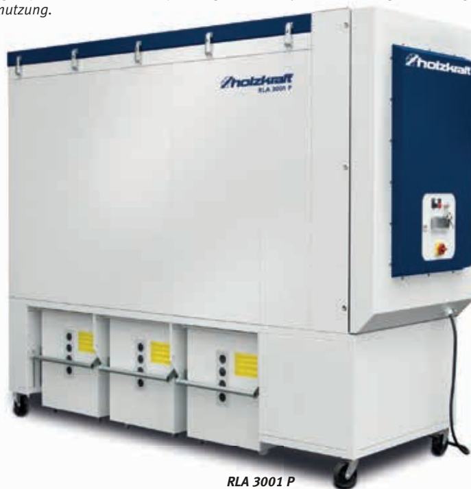
Abreinigung erfolgt durch Druckluftimpulsstöße, die den Filter von innen nach außen abreinigen. Die dadurch hervorgerufene mechanische Verformung der Filter optimiert den Regenerationsgrad bei starker Verschmutzung.
