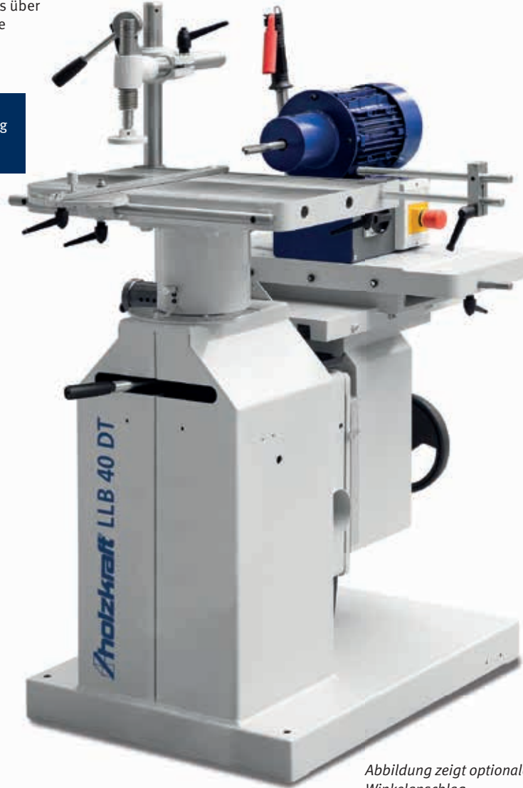
▶ Manueller Exzenterstapser mit großem Auflageteller zum Fixieren des Werkstücks
