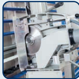
▶ Große Öffnung für Sägeblattwechsel
