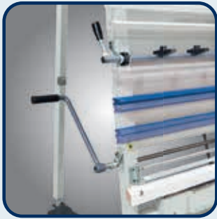
▶ Um zu verhindern, dass das Sägeblatt in eine Rückwandleiste hineinsägt, Lattenrost manuell verschiebbar
