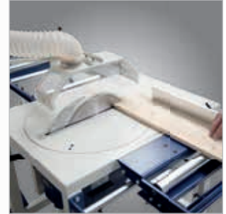
Sägeblattdrehung um bis zu 90°
