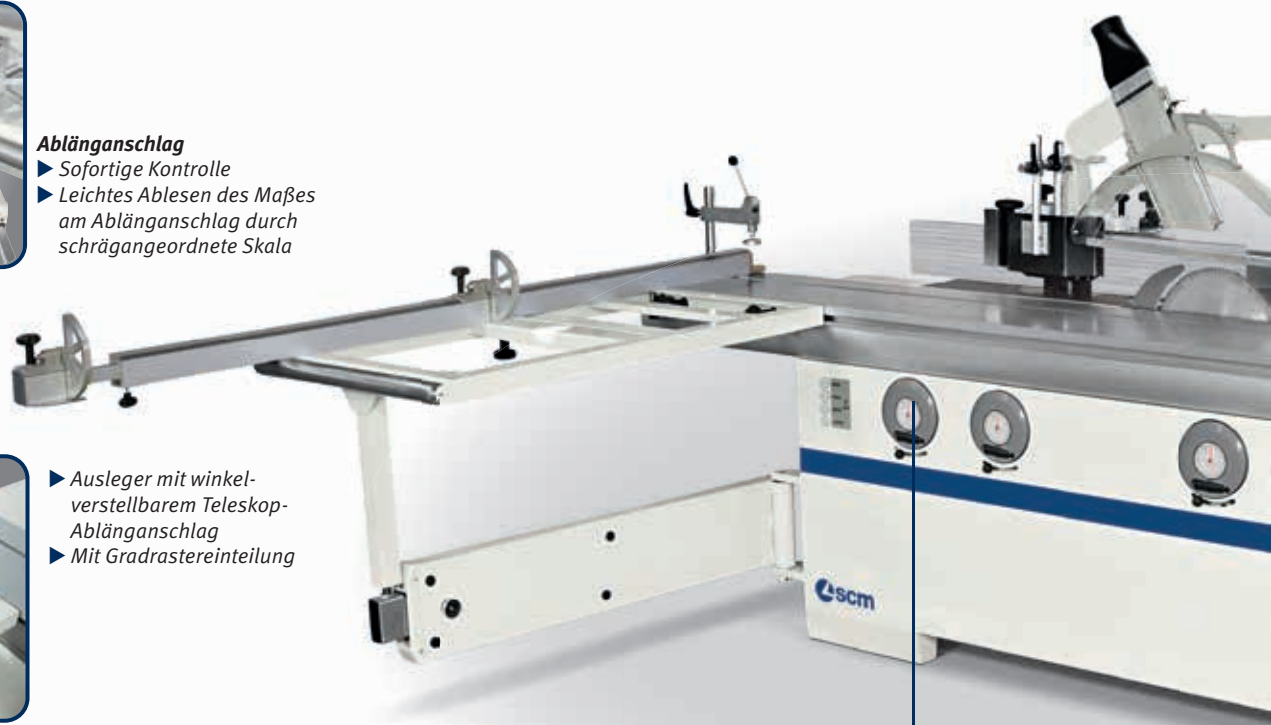
Mit festen Handrädern mit integrierter Gradanzeige
