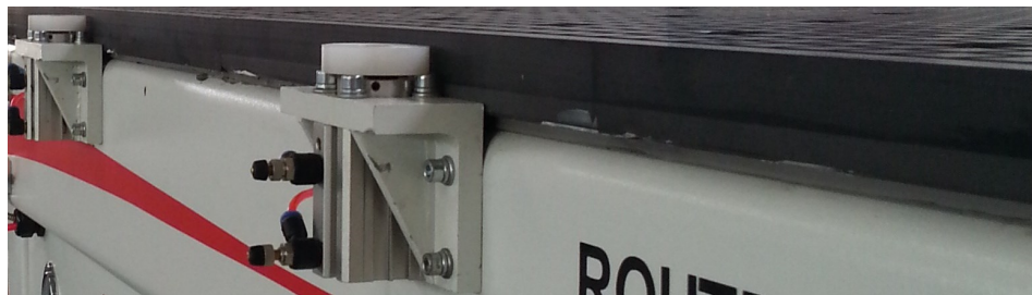
Bild 12. Pneumatische Anschläge für X und Y Achse
