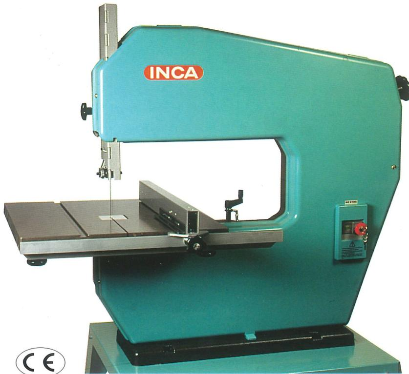
Das Gehäuse der Inca Expert 500 ist eine stabile Aluminium-Druckguss Konstruktion. Die durchdachte Verrippung des Gehäuses bedingt günstige Verhältnisse zwischen Gewicht und Stabilität. Der Bandsägetisch kann bis 20° geneigt werden. Die gewünschte Schräge kann an der Skala unter dem Tisch exakt eingestellt werden. Der grosse Durchlass ermöglicht, auch grosse Stücke mit dem Feinschnittband 20 zu bearbeiten.
