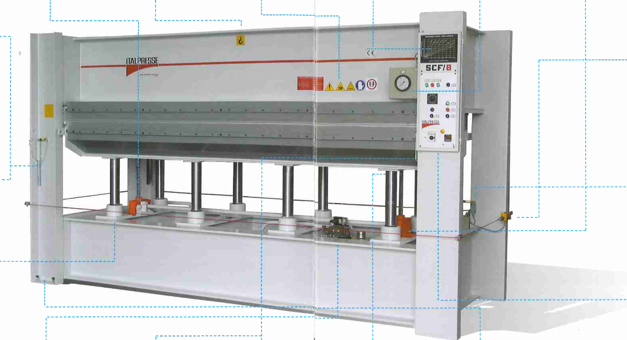
Chiavistello per bloccaggio piani in fase di manutenzione Safety lock Verriegelungsbolzen für die Heizplatte bei Wartungsarbeiten
