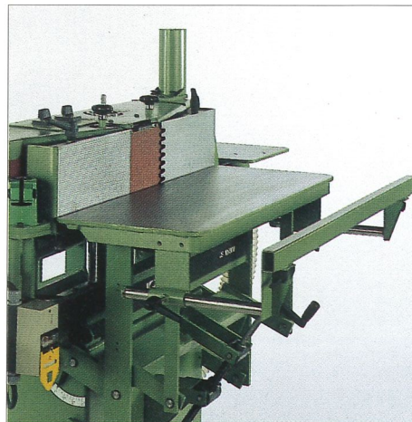
Ausziehbare Tischverbreiterung für große Werkstücke.
