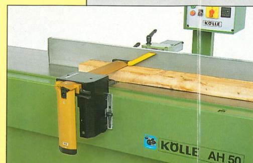
Die SUVAMATIC-Hobelschutzeinrichtung ersetzt den Klappenschutz und die Fügeleiste und entspricht dem neuen CEN-Norm-Entwurf. Der Gliederschwingschutz, siehe Abbildungen AH 40 und AH 63 ist nach dieser Norm nicht mehr zulässig.
