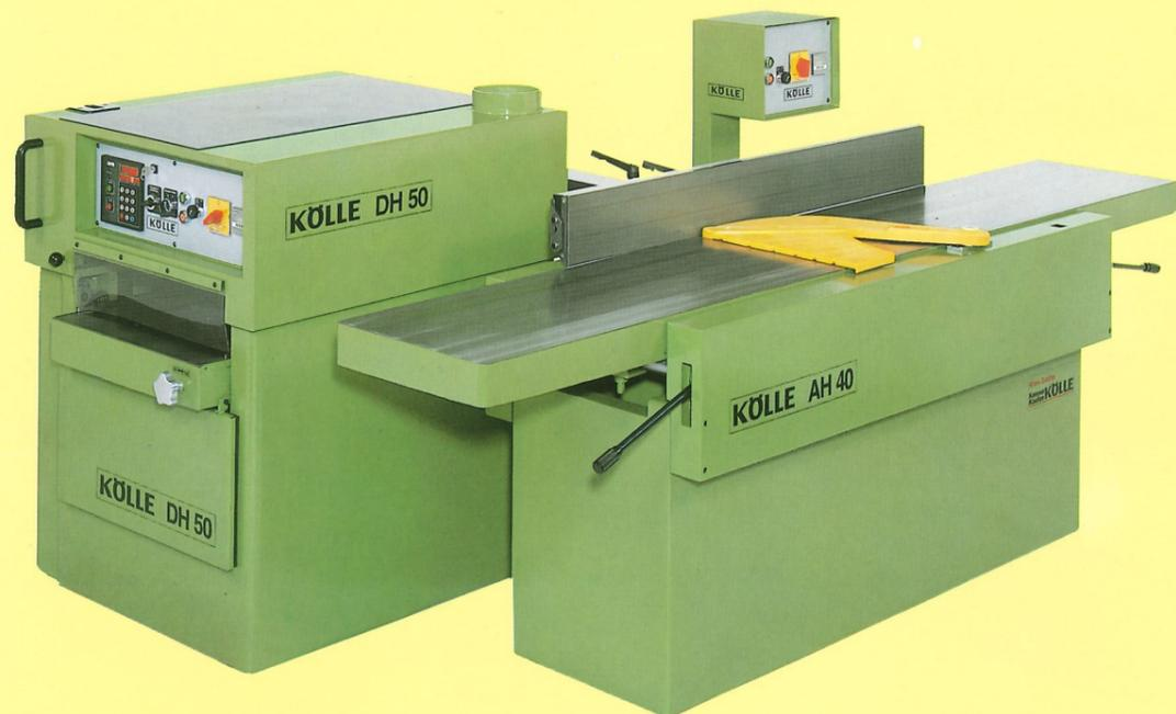
Die abgebildete Aufstellung der Abrichthobelmaschine mit der Dickenhobelmaschine gibt den besten Arbeitsablauf und erfordert den geringsten Platz. Die Dickenhobelmaschine wird am Stutzen auf der Abdeckhaube abgesaugt und die Abrichthobelmaschine an der Ständerrückseite. Die gemeinsame Absaugleitung wird zwischen beiden Maschinen installiert.
