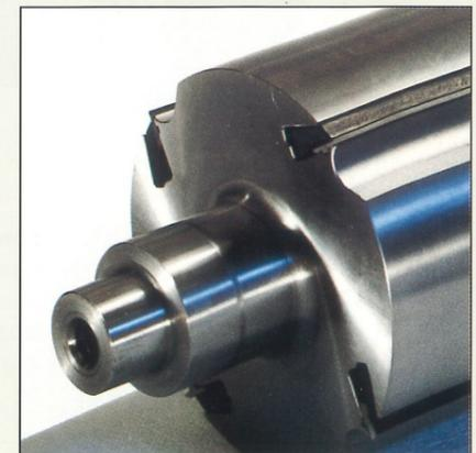
Die Centro-Fix-Messerwelle erlaubt einen Messerwechsel in wenigen Sekunden. Die Messer werden beim Anlauf der Welle von der Fliehkraft über die Druckleisten automatisch festgespannt. Zum Anfügen von beschichteten und belegten Platten können auch geteilte Messer eingesetzt werden.
