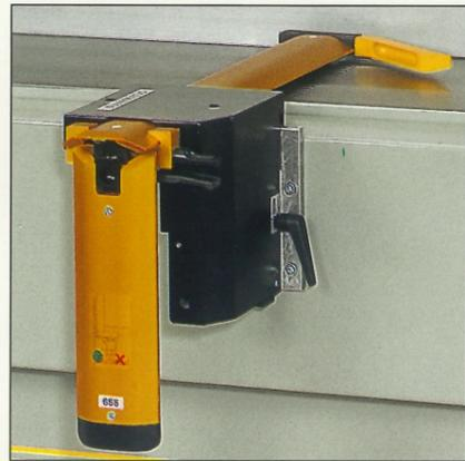
Die Suvamatic Hobelschutzeinrichtung verdeckt den ganzen Hobelbereich. Sie hebt und senkt sich beim Abrichten automatisch und preßt beim Fügen das Werkstück gegen den Fügeanschlag.
