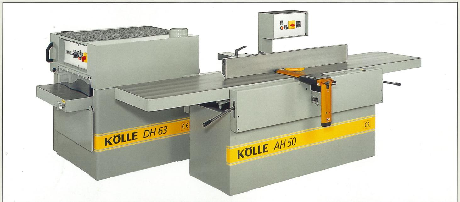
Die abgebildete Aufstellung der Abrichthobelmaschine zusammen mit der Dickenhobelmaschine gibt einen guten Arbeitsablauf und erfordert wenig Platz. Die Abrichthobelmaschine wird an der Ständerrückseite abgesaugt und die Dickenhobelmaschine am Stützen auf der Abdeckhaube. Die gemeinsame Absaugleitung wird zwischen beiden Maschinen installiert.
