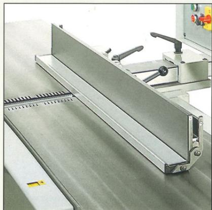
Hohe Genauigkeit beim Fügen. Abrichttische mit verwindungssteifer Rippenanordnung und schwingungsfreier Tischlagerung. Leichter Werkstückvorschub durch die in Längsrichtung feingehobelte Tischflächen.
