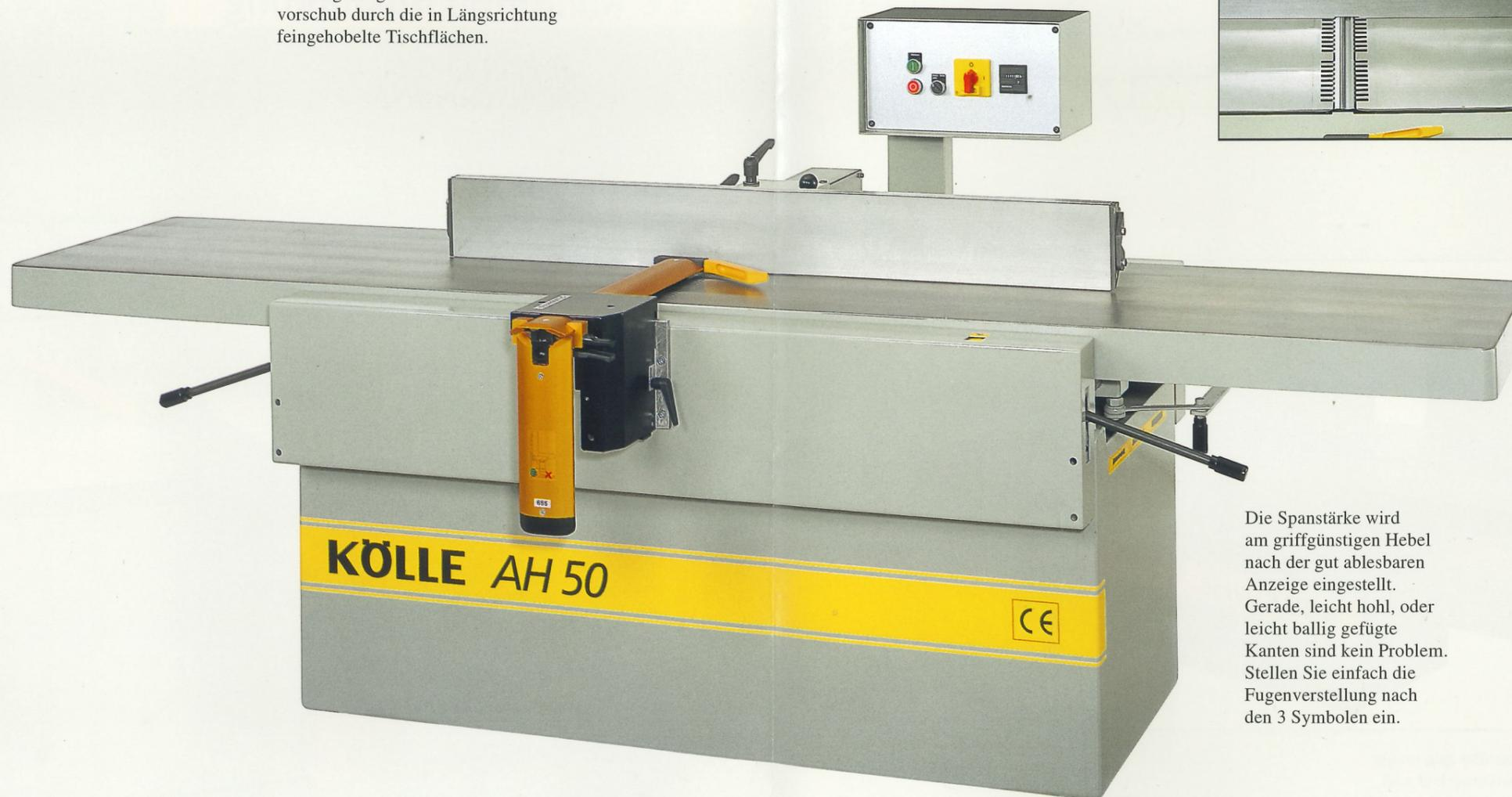
Die Spanstärke wird am griffgünstigen Hebel nach der gut ablesbaren Anzeige eingestellt. Gerade, leicht hohl, oder leicht ballig gefügte Kanten sind kein Problem. Stellen Sie einfach die Fugenverstellung nach den 3 Symbolen ein.
