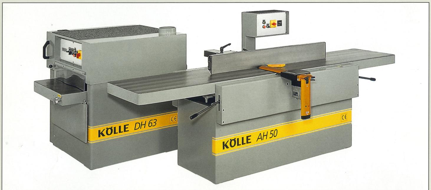
Die abgebildete Aufstellung der Abrichthobelmaschine zusammen mit der Dickenhobelmaschine gibt einen guten Arbeitsablauf und erfordert wenig Platz. Die Abrichthobelmaschine wird an der Ständerrückseite abgesaugt und die Dickenhobelmaschine am Stutzen auf der Abdeckhaube. Die gemeinsame Absaugleitung wird zwischen beiden Maschinen installiert.
