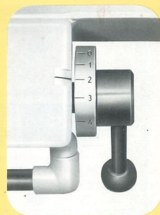
Die Abrichtspantiefe wird am Verstellhebel angezeigt.
