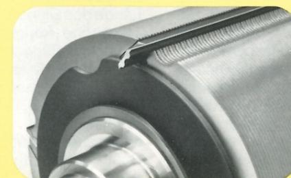
TERSÄ-Messerwelle mit Messerwechsel in wenigen Sekunden und automatischer Messerspannung.
