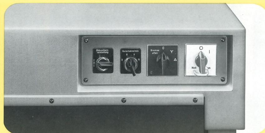
Die Bedienschalter sind in die Frontseite der Abdeckhaube versenkt eingebaut. Dickentischverstellung, Vorschubgeschwindigkeit und Hobelmotor werden hier bequem betätigt.
