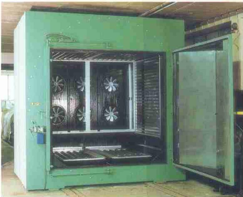
Vakuum Großraum-Trockner in Elementbauweise für 30-65 m<sup>3</sup>
