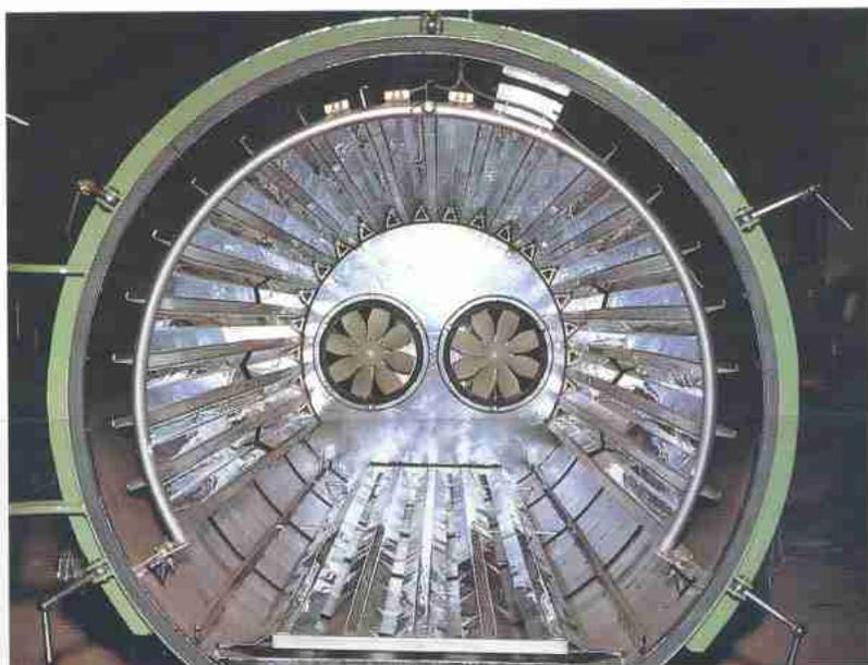
Behälter geöffnet. Deutlich erkennbar der Spezial- Heizkörper mit Steckbuchsen für die Holzfeuchtemessung, das Kühlregister, die an der hinteren Stirnwand angebrachten Ventilatoren und die Laufschienen.
