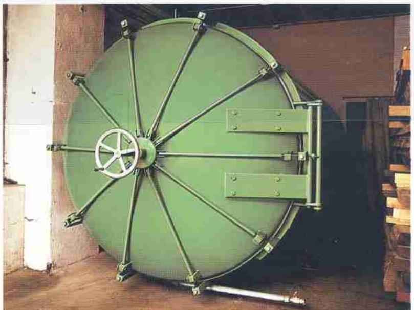
Neuentwickelte Zentralverriegelung mit Handrad zum schnellen, bequemen Öffnen und Schließen des Behälters als Sonderausführung.
