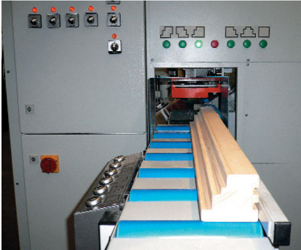
Standardprofilvorwahl per Taster mit 6 Grundprofilen
