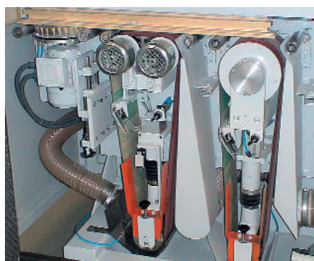
Je Seite 2 Schleifbänder + Disc. Top-Finish für Fenstererteile
