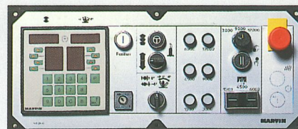
T 252 B 2-Achsen-Steuerung mit Tastatureingabe und Speicher für 100 Maßpaare.
